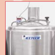
Sistema di chiusura ermetico del bollitore.
